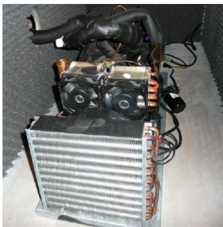
Fig. 24: Radiador y ventiladores
