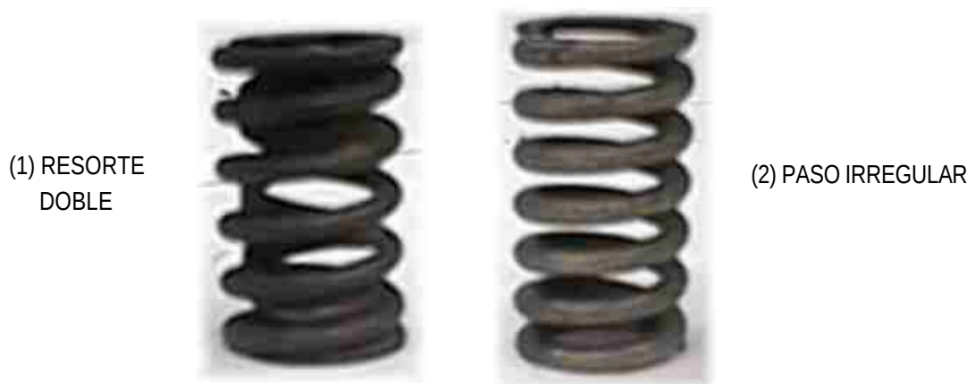
Fig. 37: LOS RESORTES DE LA VÁLVULA
